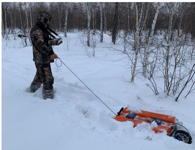
Рис.3. Георадиолокационная съемка на участке работ
